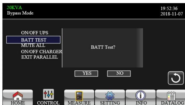
Figura 5.9 - Inicio del Test de batería
