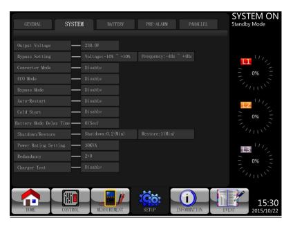
Figura 5.15 - Pantalla SETUP/CONFIGURACIÓN DEL SISTEMA
